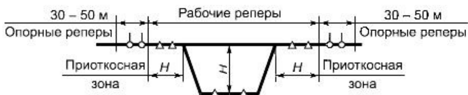
б) Разрез сооружения
