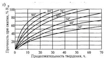
Рис. 9 графики набора прочности бетоном при различных температурах его выдерживания
