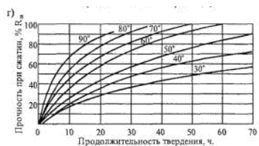
Рис. 9 графики набора прочности бетоном при различных температурах его выдерживания
